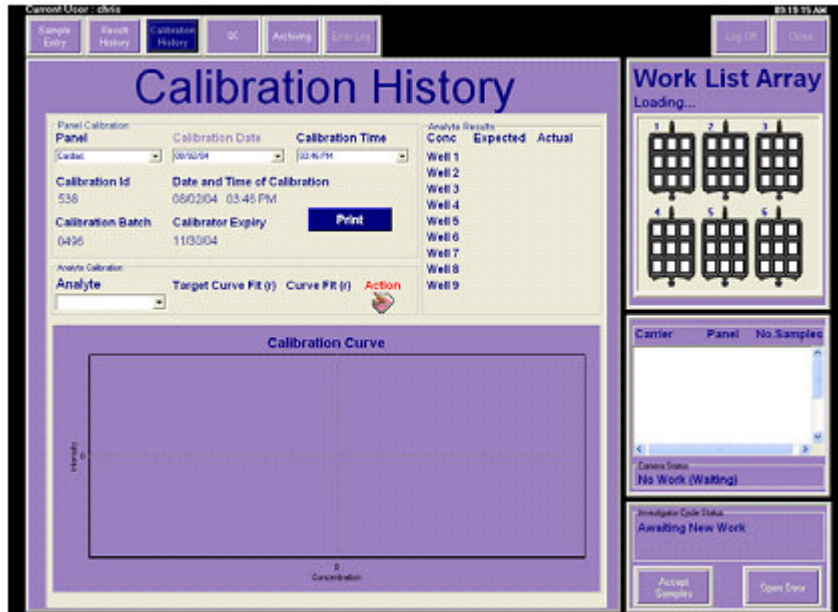
图 6.6 失败的校正（无可用的有效校准曲线）
