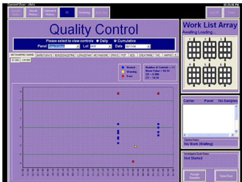
图 6.19 Levy-Jennings 图 数据点的颜色-编码系统使用如下：
